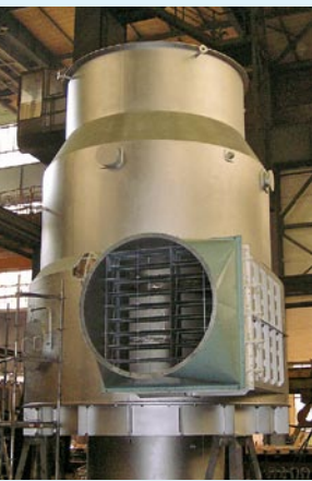
SAACKE Typ HRS 450 GCU for British Emerald 4,5 t/h (100% CH 4 )
